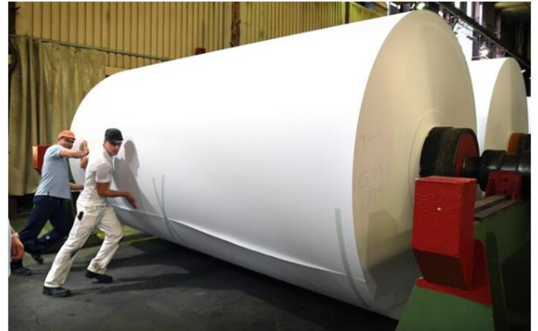
Papierfabricage bij Sappi in Maastricht. Het papier wordt gedroogd met stoom, waarvoor het bedrijf elektrische boilers gebruikt. Beeld Marcel van den Bergh / de Volkskrant
